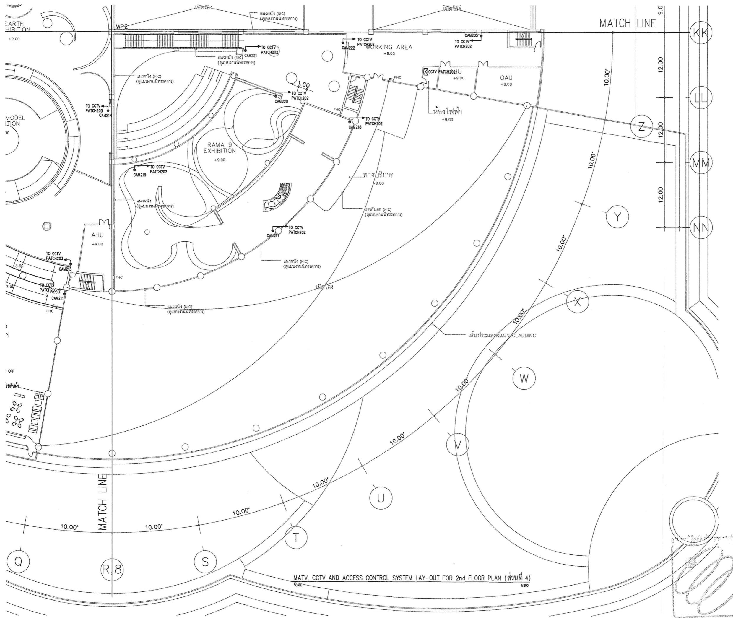
MATV, CCTV AND ACCESS CONTROL SYSTEM LAY-OUT FOR 2nd FLOOR PLAN (ส่วนที่ 4)
